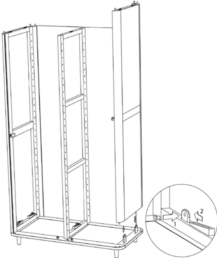
**4.** Die zweite Seitenwand auf die Holzlaschen der Bodenplatte stellen. Holzdübel durch die Lasche stecken (1), Spannkeil auf die Lasche stecken (2) und mit einem Hammer gefühlvoll „auf Zug“ festklopfen.
