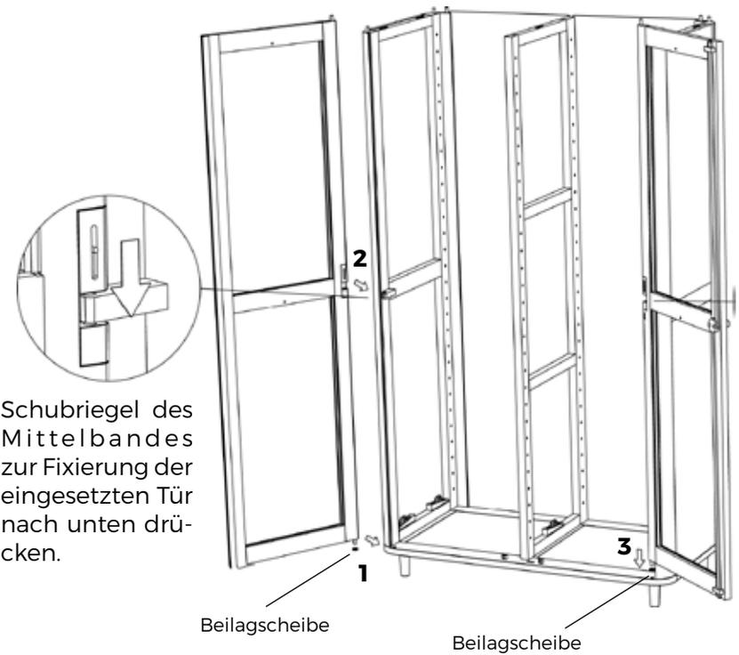
Schubriegel des Mittelbandes zur Fixierung der eingesetzten Tür nach unten drücken.
