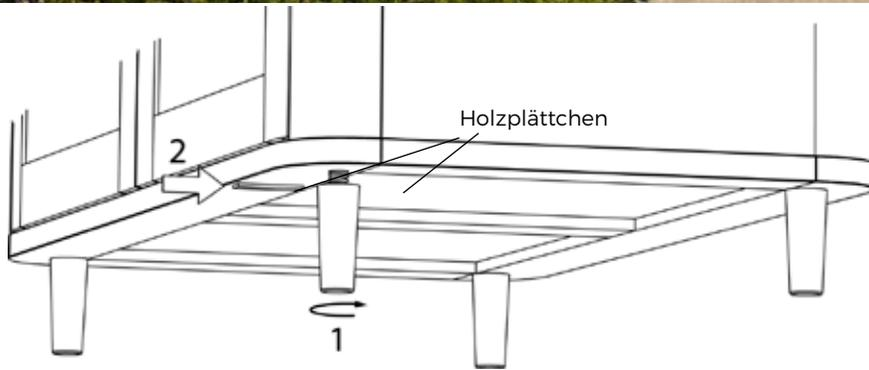
**9.** Schrank an den endgültigen Aufstellplatz stellen. Für eine gleichmäßige Fuge zwischen den Türen den Schrank ins Lot bringen. Dazu den/die entsprechenden Fuß/Füße ein wenig herausdrehen (1). Falls notwendig, zur Entlastung des Holzgewindes pro Fuß 2 Holzplättchen zwischen Bodenplatte und Fuß einklemmen (2). Füße nicht weiter als 8 mm herausdrehen!
