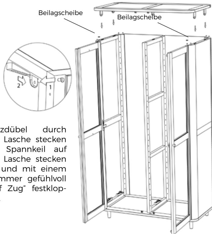
Holzdübel durch die Lasche stecken (1), Spannkeil auf die Lasche stecken (2) und mit einem Hammer gefühlvoll „auf Zug“ festklopfen.
