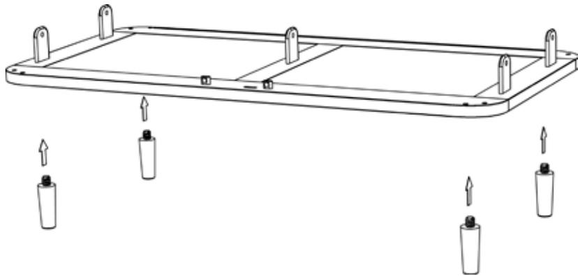
**1.** Füße in die Bodenplatte einschrauben – noch nicht zu fest, denn vielleicht müssen die Füße etwas später zum Ausgleich von Bodenebenenheiten wieder ein Stück herausgeschraubt werden.
