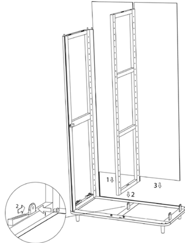
**3.** Die erste Rückwand in die Nuten der Seitenwand und Bodenplatte stecken (1). Den Innenrahmen auf die Bodenplatte stellen (2) und – wie zuvor die Seitenwand – mit Spannkeilen fixieren. Dann die zweite Rückwand montieren (3).
