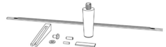
Kleinteile zur Montage: Spannkeile, Holzdübel, Holzstifte, Holzplättchen, Fachbretträger, Beilagscheiben, Klemmleisten zur Fixierung der Türfüllungen und Füße.
