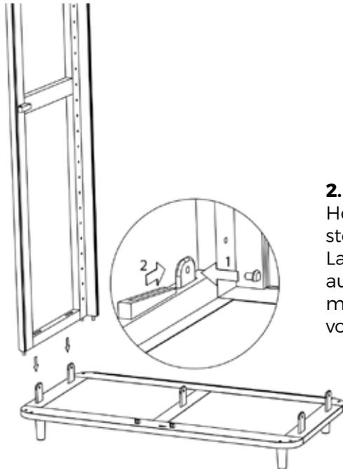
**2.** Die erste Seitenwand auf die Holzlaschen der Bodenplatte stellen. Holzdübel durch die Lasche stecken (1), Spannkeil auf die Lasche stecken (2) und mit einem Hammer gefühlvoll „auf Zug“ festklopfen.
