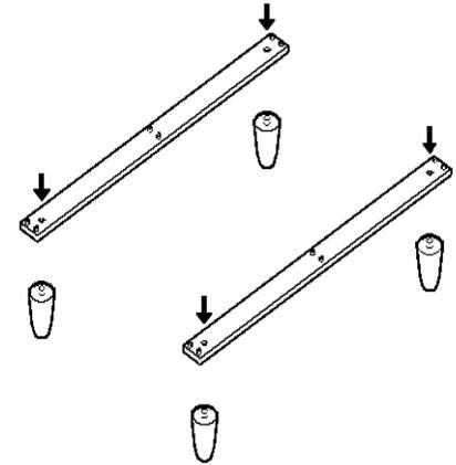
2. Stellen Sie diese beiden Fußgestelle auf den Boden und verbinden Sie sie wie abgebildet mit den beiden Seitenwangen. Heben Sie diese dabei leicht an, sodass die Holzdübel besser in die entsprechenden Bohrungen gesteckt werden können.
