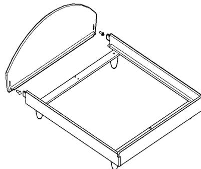
5. Mittelsteg mit Mittelfuß von oben auf die Fußgestelle stecken. Dann kann der Lattenrost in den Corpus eingelegt werden. Hinweis: Bei der Bettbreite 140 cm gibt es keinen Mittelsteg.
